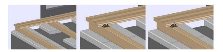
Schneiden Sie für die 2 Reihe eine Diele so ab, dass die Diele mindestens auf 2 Hölzern aufliegt. Das muss auch bei dem letzten Brett auf der anderen Seite so gemacht werden. Stecken Sie die komplette Dielenreihe auf die Klammern der vorherigen Reihe und verschrauben die nächsten Klammern mit der Unterkonstruktion.
